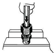
4. Matici běžnou silou přitáhnout klíčem asi o 1-1,5 otáčky. Kontrola: matici uvolnit a zkontrolovat, zda je kroužek zaříznutý. Pokud není, je třeba přitáhnout. Není na závadu, pokud se kroužek na trubce otáčí, nesmí se však posouvat ve směru osy trubky.
