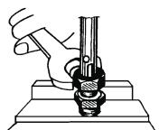
5. Minimální výška přímé části trubky před ohybem se rovná dvěma výškám převlečné matice.
